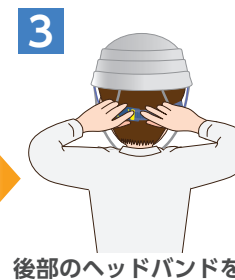
同時に帽体の左右をつかんで 「カチッ、カチッ、カチッ」と 3箇所音がなるまで下におろす
